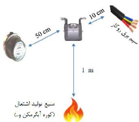
**پاسخ:** طبق مبحث ۱۷ بند ۴-۳-۲-۴-۱۷ ج، صفحه ۳۱ «فاصله‌ی کنتور از سیم‌های برق که روی کار نصب شده‌اند باید حداقل ۱۰ سانتی‌متر و از کنتور برق ۵۰ سانتی‌متر باشد.» (شکل روبرو از جزویه گازکشی از مجموعه جزوایت مبحث ۱۷ تألیف همین مؤلف است).
